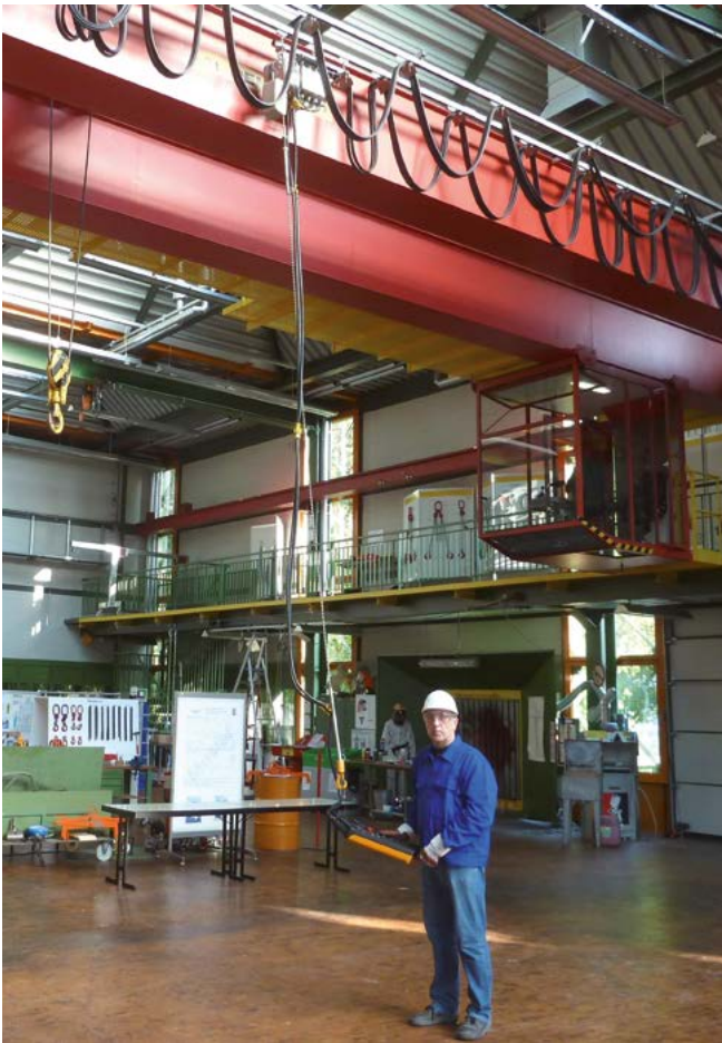
Bild 3-1: Krananlage, die wahlweise vom Führerhaus oder von Flur aus gesteuert werden kann
