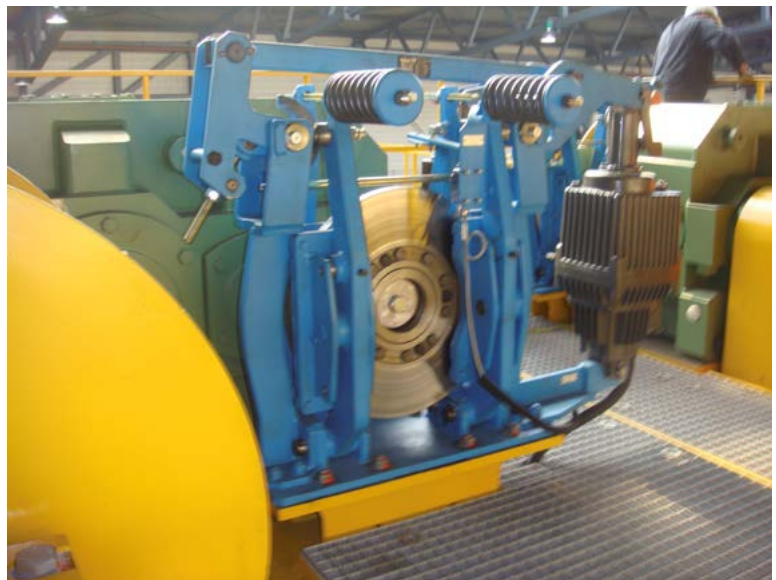
Bild 4-5 Inaugenscheinnahme einer Scheibenbremse
