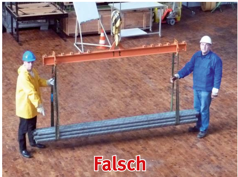
Bild 5-15: Beine der Anschläger befinden sich im Gefahrenbereich
