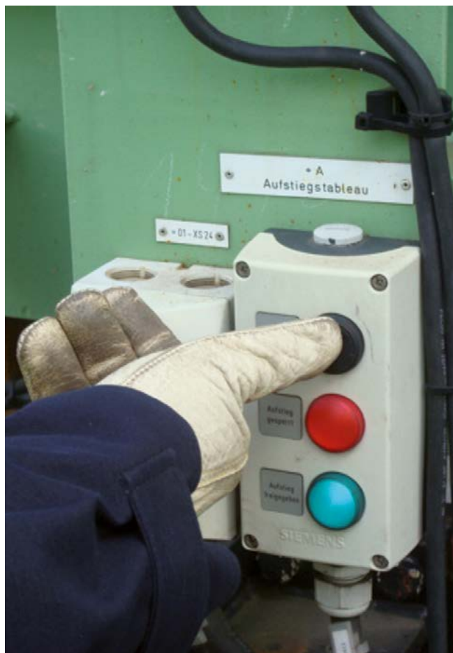
Bild 3-9: Der Ablöser gibt dem Kranführer Signal, dass er den Kran betreten will.
