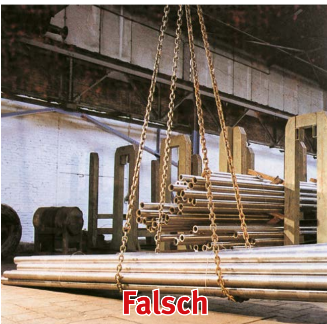
Bild 5-17: Die Reibung zwischen Last und Ketten ist so gering, dass die Ketten beim Anheben zusammenrutschen und die Last aus den Ketten fällt
