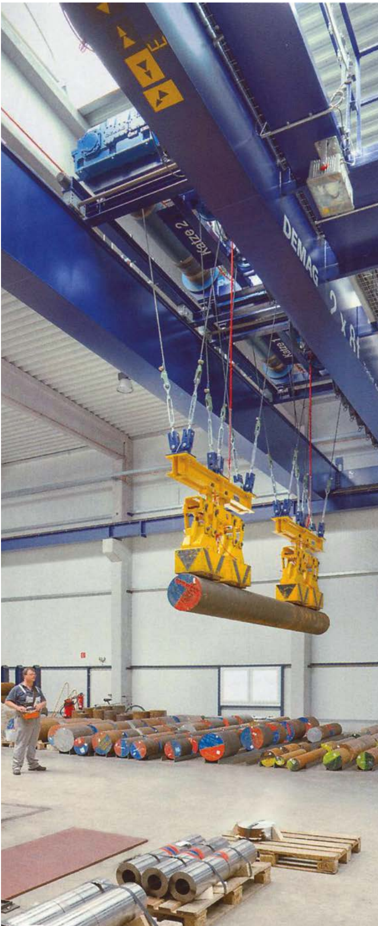
Bild 5-6: Der Kranführer steuert den Kran aus sicherer Entfernung zur Last, die nur durch Magnetkräfte gehalten wird
