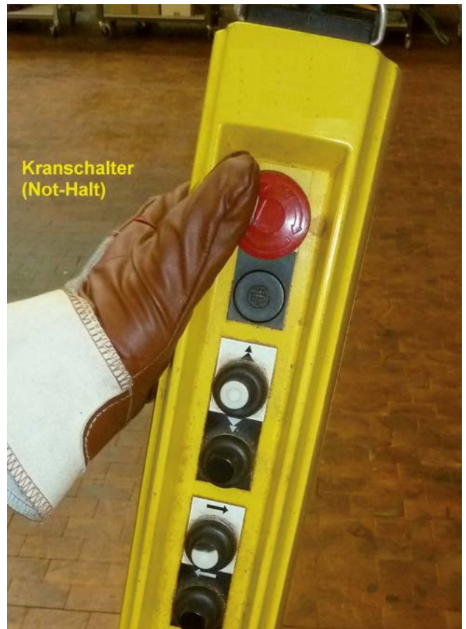
Bild 7-3: Bei flurgesteuerten Krane wird der Kranschalter durch Drücken des auch als „Not-Halt-Schalter“ bezeichneten roten Pilztasters betätigt
